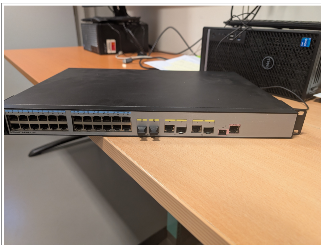
Figure 1 : Face avant du switch Huawei S5700-28TP-PWR-LI-AC : 24 ports RJ45 (1–24), ports STACK (25–26), ports combo 1 G (27–28) et, à droite, le port CONSOLE (connecteur RJ45 rose) ainsi que le port mini-USB. C'est le port CONSOLE qui sert de point d'entrée pour la réinitialisation.
