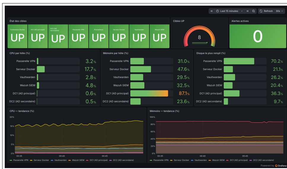
Figure 4 : La vue d'ensemble en page d'accueil : état des huit cibles, jauges par hôte et alertes actives, visibles dès la connexion.
